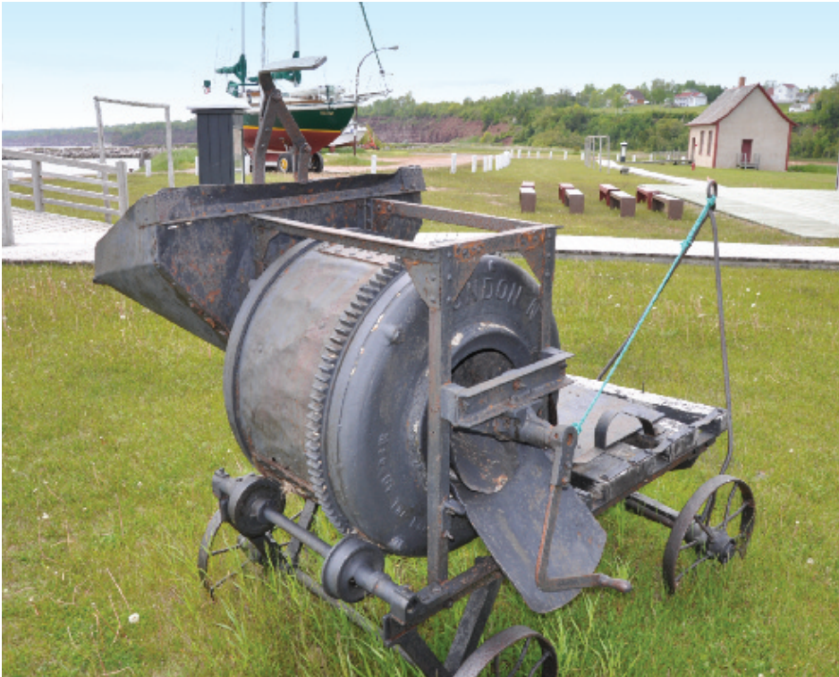
Bétonnière London, tout début XX e siècle, ancêtre des bétonnières d'aujourd'hui, Site historique national de Paspébiac, Gaspésie.
